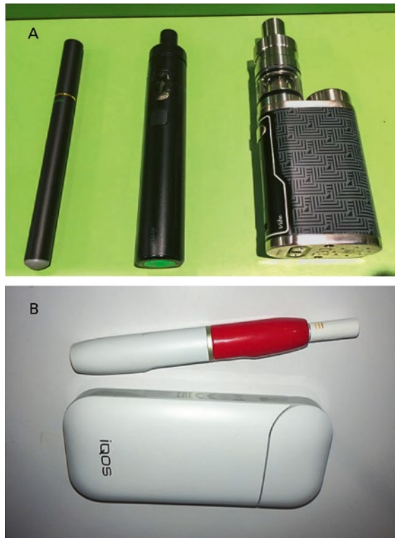
Figure 1: Cigarettes électroniques de la première, deuxième et troisième génération, et un appareil «heat but not burn». A: Cigarettes électroniques de première génération, en partie également nommées e-shishas (à gauche), e-cigarette de deuxième (au milieu) et de troisième (à droite) génération (aussi nommées MODS ou «tanks»). B: Appareil «heat but not burn» se composant du support électronique avec un élément chauffant et du heat-stick (contient le tabac et le filtre). A côté, l'unité de chargement mobile est montrée [3].
